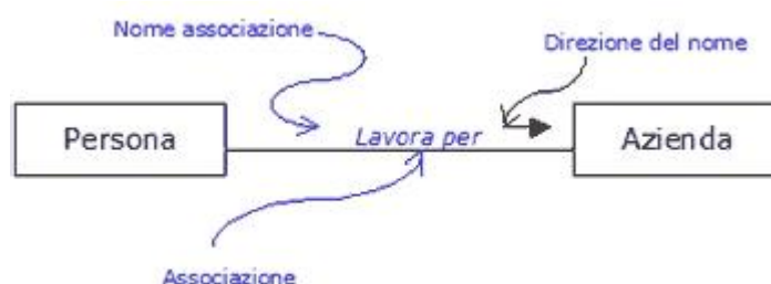
Figura 1. Diagramma di una relazione di associazione
